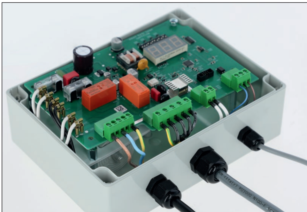
Figura 9: Scheda nell'alloggiamento dell'unità di controllo (condensatore dietro la scheda)
