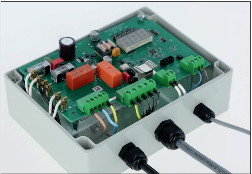
Abbildung 9: Platine in Steuerungsgehäuse (Kondensator hinter der Platine)
