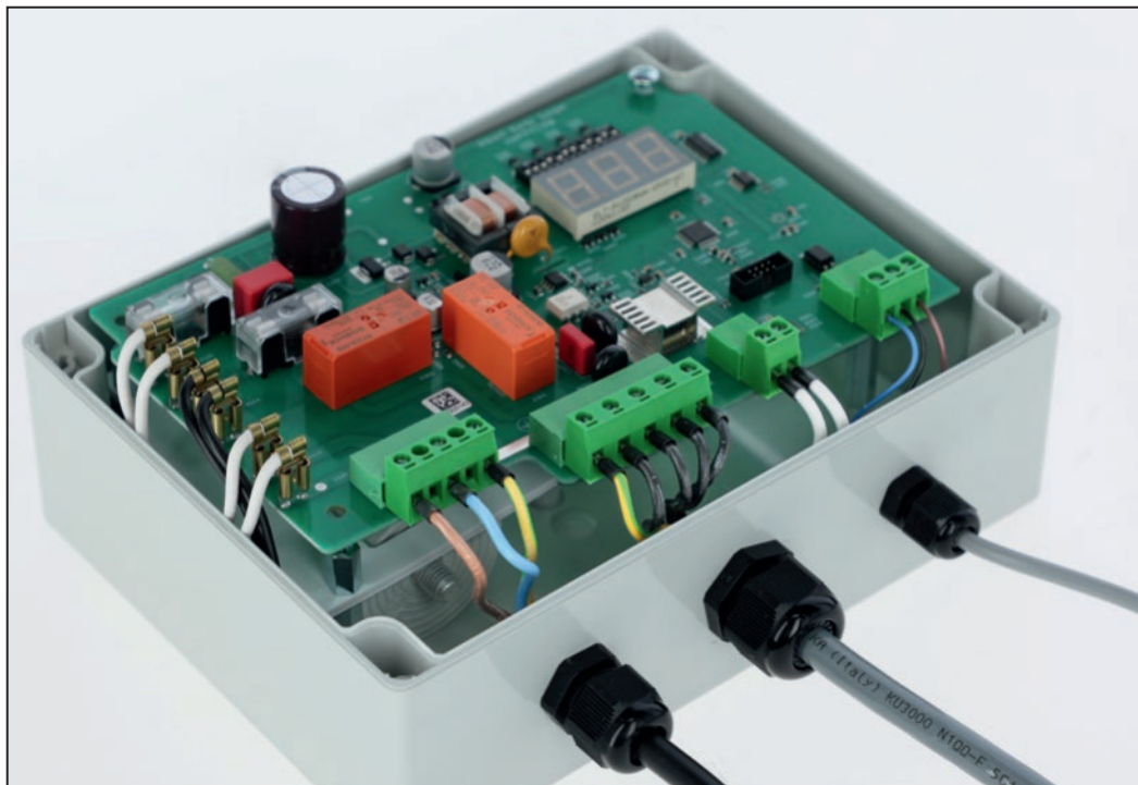
Rysunek 9: Płyta w obudowie sterownika (kondensator z tyłu płyty)
