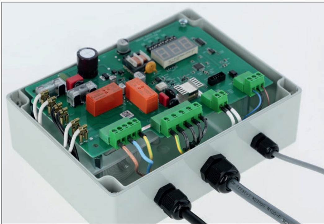
Illustration 9: Printkortet i styringshuset (kondensator bag printkortet)
