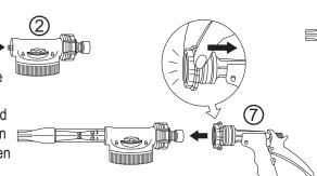
3. Schieben Sie den schwarzen Plastik-Anschluss der Schnellkupplung am Griff zurück und lassen Sie den Mischkopf am Messing anschluss dicht einrasten.
