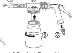
4. Befüllen Sie die Flasche mit dem gewünschten Schaummittel und platzieren Sie die Flasche unter den zusammengesetzten Mischkopf.
